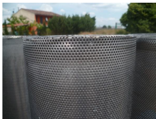
Après Traitement avec SODINOX Gel EVO : la calamine est totalement enlevée.
