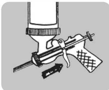
3 ■ Retourner le pistolet avec la bombe et actionner la gâchette jusqu'au nettoyage complet du pistolet.
